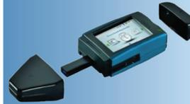
Télécharger les données de masse avec la tablette et la clé de téléchargement
